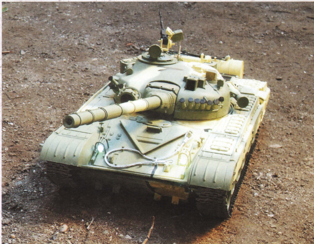
Благодаря двум электромоторам и специальному механизму, приводящему в движение гусеницы и металлические колеса, Т-72 обладает отличной маневренностью.
